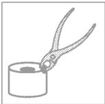
Après la coulée, laisser les cylindres refroidir à l'air, dans un endroit protégé et signalé comme tel, jusqu'à pouvoir les tenir dans la main, **ne pas les plonger dans l'eau !** Les matériaux de revêtement contiennent du quartz. Ne pas respirer la poussière ! Risque de maladies pulmonaires (silicose, cancer du poumon). Afin d'éviter la poussière lors du démoulage, immerger dans l'eau les cylindres entièrement refroidis après coulée jusqu'à ce qu'ils soient bien humidifiés.
