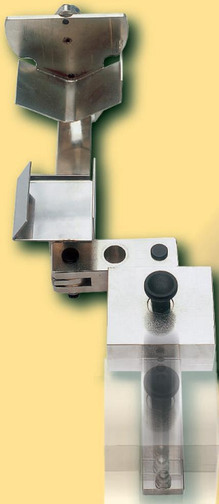
El contrapeso se desliza suavemente sobre una guía graduada con los diferentes tamaños de cilindro que se pueden montar. Para las maniobras de bloqueo y desbloqueo se emplea un pomo con tirador.
