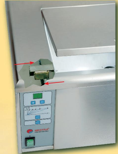
Durante el funcionamiento de la máquina la puerta de la cabina permanece bloqueada por un cierre de seguridad que evita posibles accidentes.
