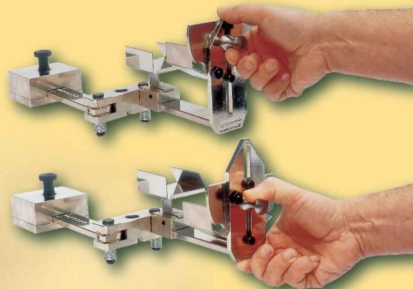
El portacilindros permite montar cilindros de hasta 100 mm. de diámetro. Mediante su sencillo sistema de regulación de altura se consigue una óptima alineación entre la boca del crisol y el bebedero del cilindro.
