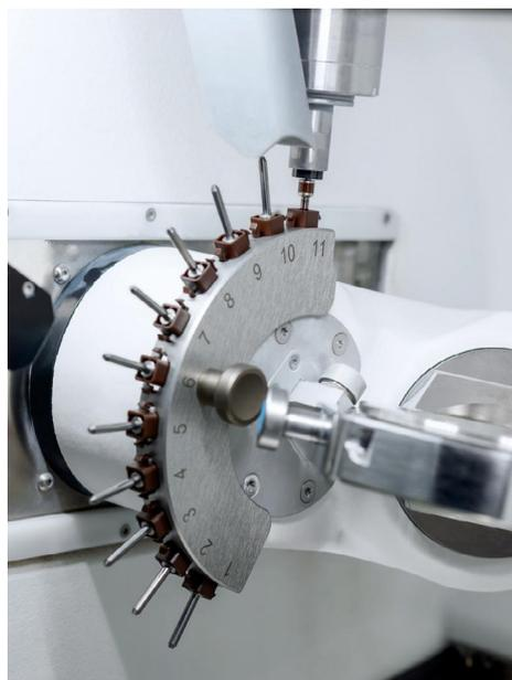
**Roto RFID ST (InCadCam)** pour parcours d'outils InCadCam sur toutes les usineuses Ceramill
